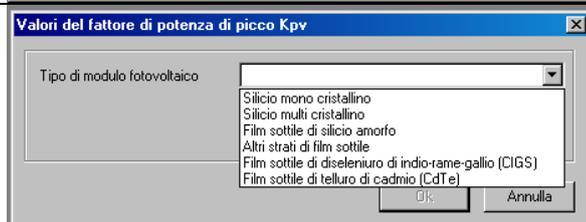
Scegliere nel menu combo l'etichetta che descrive il tipo di modulo fotovoltaico utilizzato per realizzare l'impianto in esame.
