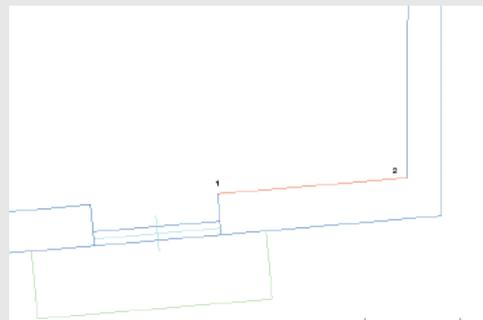
Si esegua **INSERISCI > STRUTTURA DISPERDENTE VERTICALE**. Nella successiva finestra di dialogo si inserisca il valore dell'altezza della struttura di 2,9 metri.
